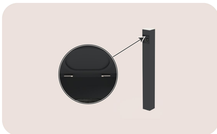
Image 23 : Vue sur les vis de la porte
