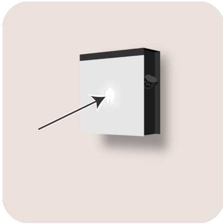
Afbeelding24: plaats van de RFID-lezer met ledlampje op de EV Wall
