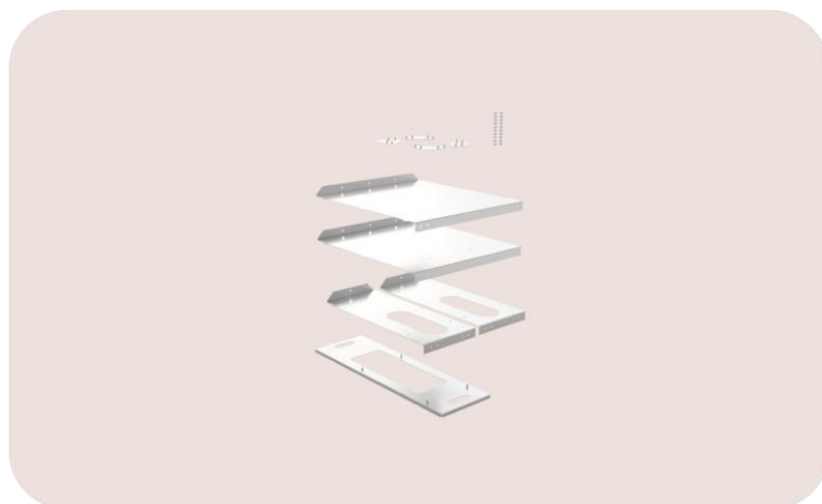
Image 4 : Pièces du kit d'ancrage EV Ultra
