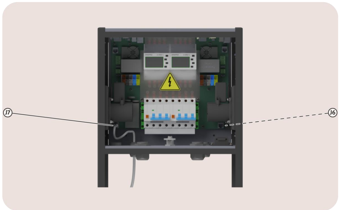
Image 36 : Vue du port J7 pour l'entrée Internet et du port J6 pour le chaînage optionnel
