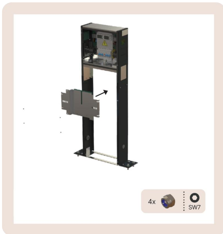
Image 18 : Vue sur le piédestal (A) et le support LED (B)
