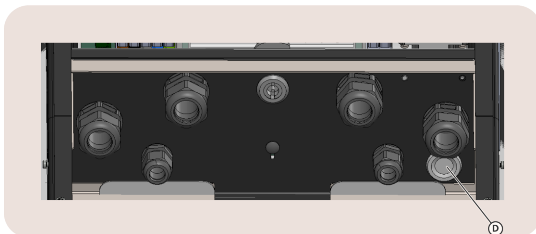
Image 21 : Vue du passe-câble (D) pour le câble de la carte LED.
