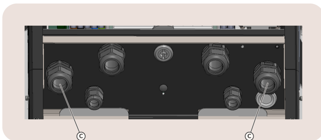
Image 31: Vue des presse-étoupes pour les câbles de recharge (C).
