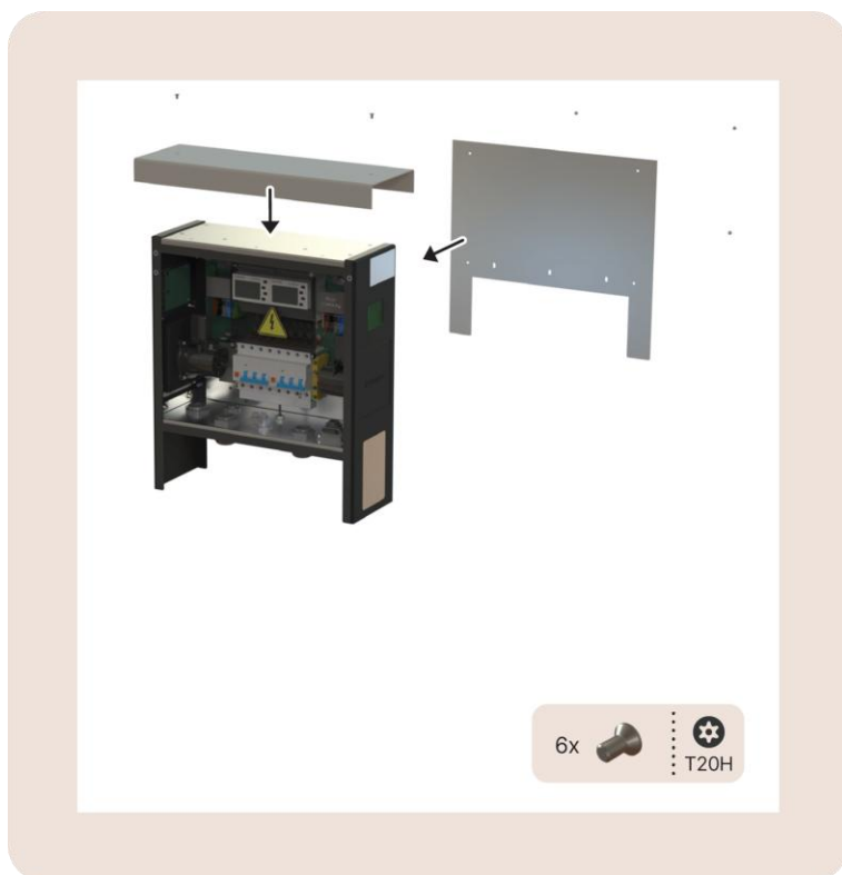
Image 24: Vue de la platine supérieure (A) et de la platine arrière (B)
