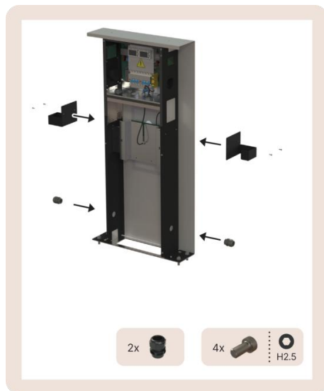
Image 15 : Vue sur le piédestal (A) et les bouchons (B)
