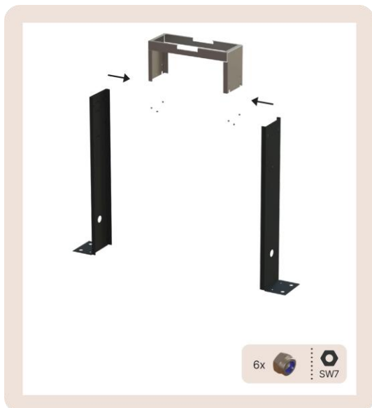
Image 13 : Vue sur la traverse (A) et les supports latéraux (B)
