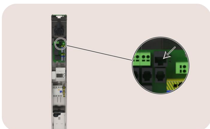
Afbeelding24: aanzicht op de A+B-poort van het relaisbord
