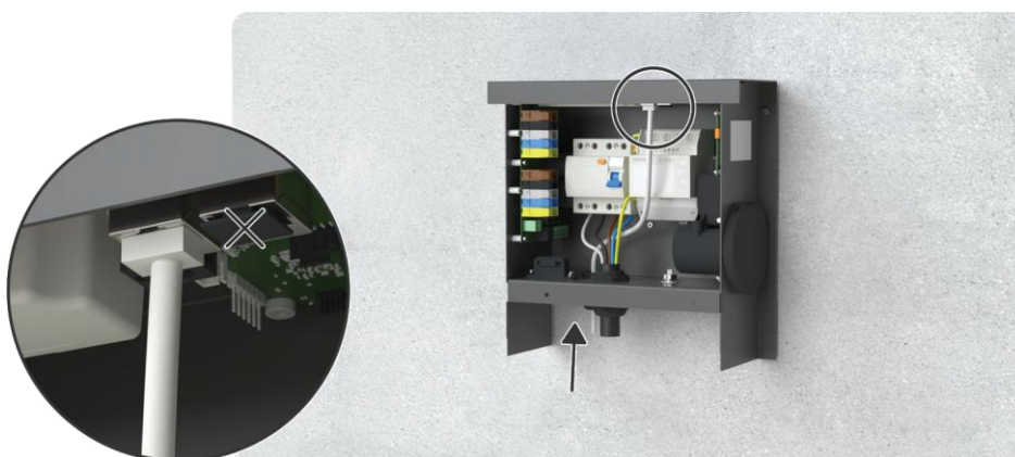
Afbeelding 24: De netwerkkabel aansluiten
