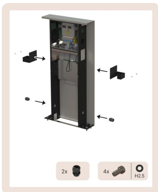
Abbildung 14: Blick auf das Ladesäule (A), die Kabelhalter (B) und die Kabelverschraubungen (C)
