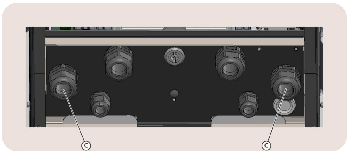
Abbildung 31: Blick auf die Kabelverschraubungen für die Ladekabel (C).
