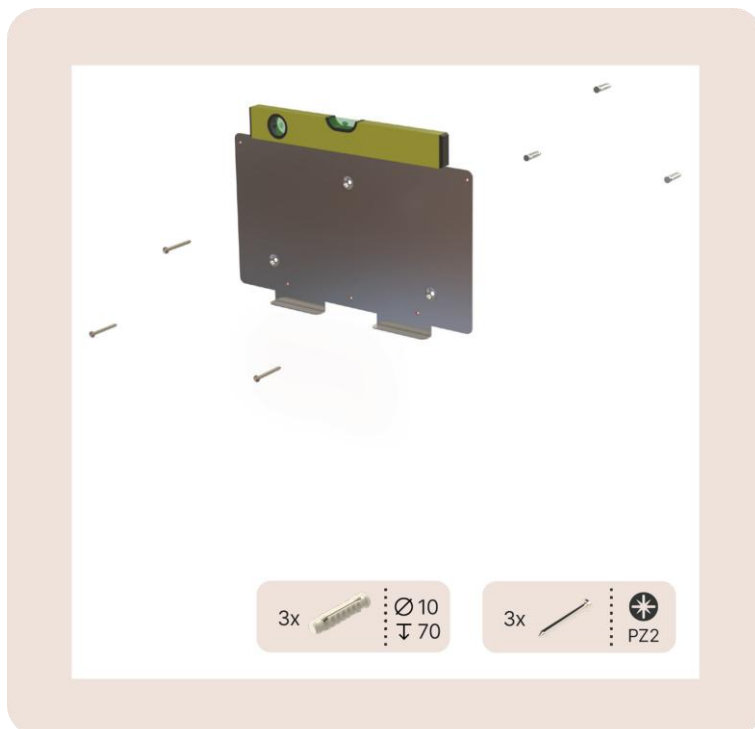
Abbildung 23: Blick auf die Wandmontageplatte (A) und eine Wasserwaage (B)
