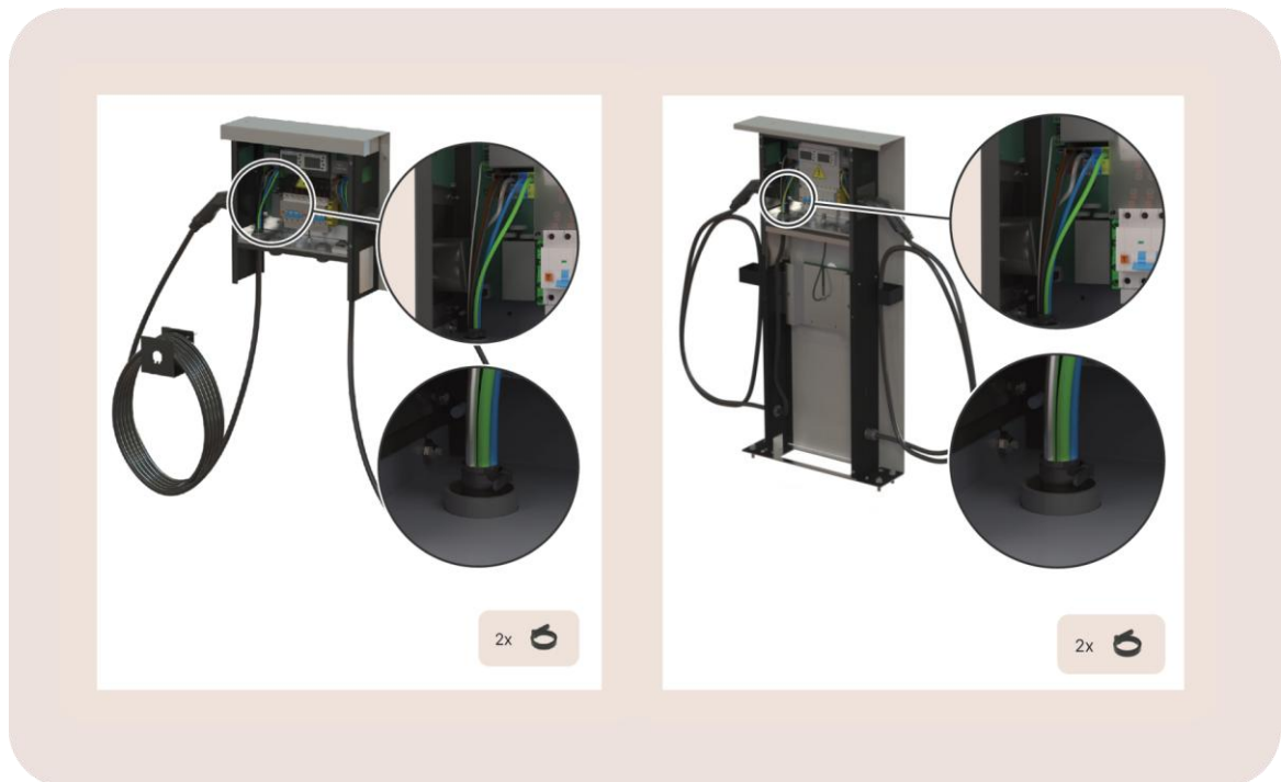
Abbildung 32: Sehen Sie sich die Kabelanschlüsse für ein an der Wand und am Boden montiertes EV Dual an
