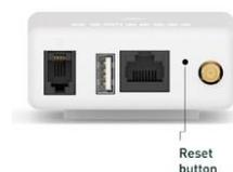
**Werksreset:** Führen Sie einen Werksreset durch, wenn Sie einen Smappee Infinity Monitor an einem anderen Ort neu installieren oder wenn Sie mit den Werkseinstellungen beginnen möchten. Drücken Sie die Reset-Taste der Genius mit einem kleinen Stift, bis das Licht nach etwa 20 Sekunden blau leuchtet. Während dieses Vorgangs leuchtet die Genius zunächst lila, dann gelb, dann ohne Farbe und schließlich blau.
