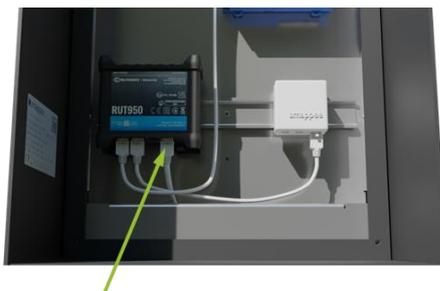
Ein Router schafft ein kleines, privates Netzwerk innerhalb der EV Ultra, um die Netzwerkkonnektivität für alle Komponenten zu gewährleisten. Dieses private Netzwerk wird innerhalb des Subnetzes 192.168.37.0 erstellt. Es gibt eine 4G-Verbindung, die als Backup konfiguriert ist, für den Fall, dass die kabelgebundene Internetverbindung ausfällt.
