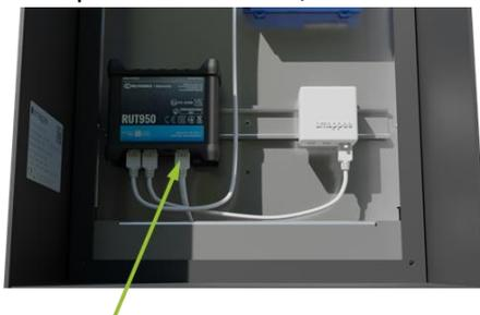
Un routeur permet de créer un petit réseau privé pour l'EV Ultra, afin d'assurer la connectivité au réseau de tous ses composants. Ce réseau privé est créé dans le sous-réseau 192.168.37.0. La connexion 4G est configurée comme connexion de secours, en cas de défaillance de la connexion Internet filaire.
