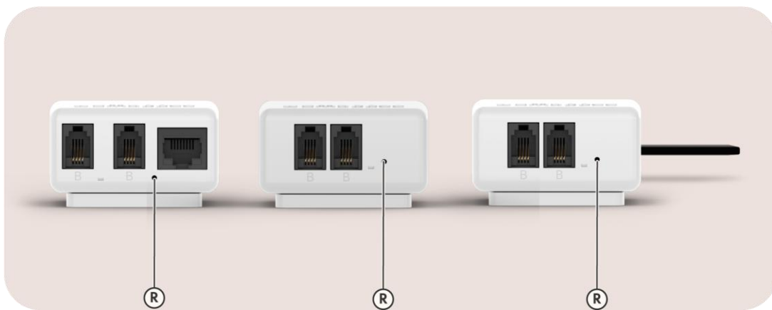
Afbeelding 17: aanzicht van de resetknoppen van de Connect, Wi-Fi Connect en 4G Connect
