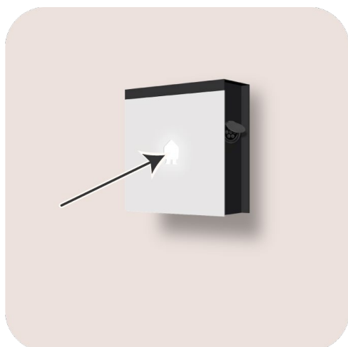
Image 24 : Position du lecteur RFID avec LED sur l'EV Wall
